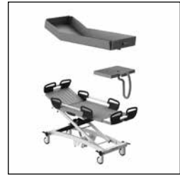
Figuur 20 Demontage ligplaat en matras.
